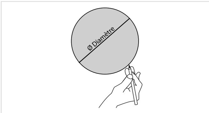
Découpez un trou à l'emplacement de montage souhaité dans le plafond. Assurez-vous que la dimension correspond à la découpe nécessaire à l'enceinte à installer.
