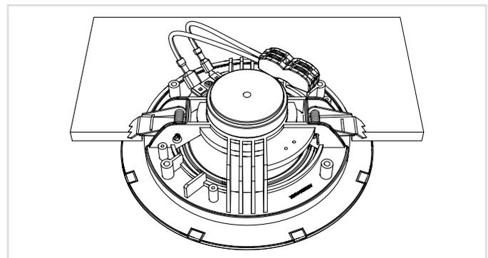
Insérez l'enceinte au travers la découpe effectuée dans le plafond, assurez-vous que les bras de montage à ressort sont bien passés derrière la surface de fixation et relâchez-les. L'installation est correcte quand le plafond est pincé entre les bras de montage à ressort et le baffle de l'enceinte.
