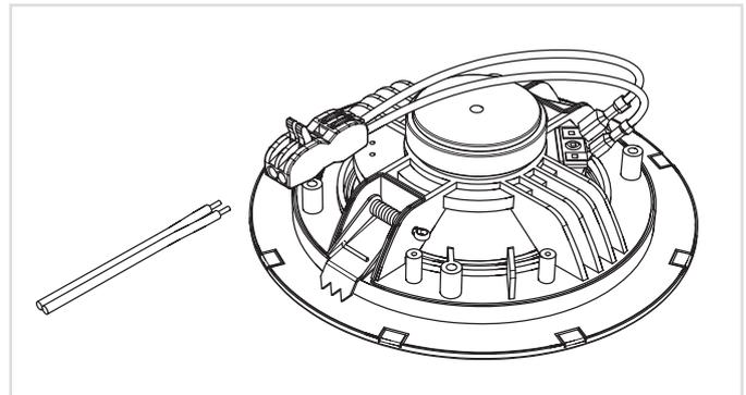
Connectez les fils venant de l'amplificateur aux borniers situés à l'arrière de l'enceinte.
